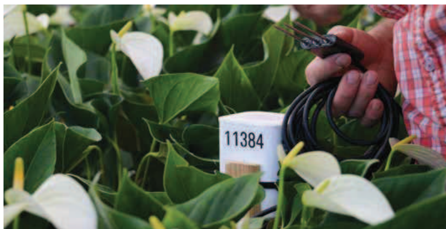
De Soil Pro meet daglicht, luchtvochtigheid, temperatuur, bodemvochtigheid, EC en de worteltemperatuur.
